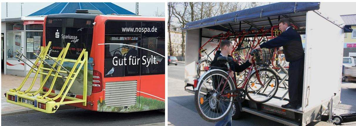
Abbildung 47 Fahrradträgersystem am Beispiel von Sylt sowie Fahrradanhänger des Nahverkehrsverbundes Paderborn/Höxter
